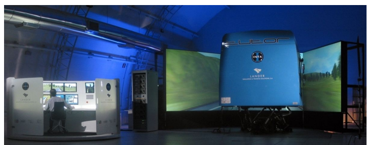
TUTOR , simulador mixto de autobús y camión. Desarrollado por Lander Simulation & Training Solutions, S.A. [2] . Instalado el año 2004 en el INTA, España.
