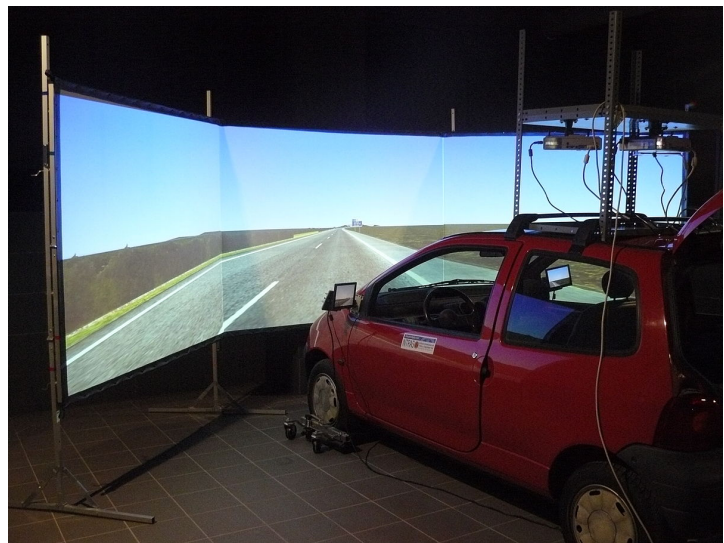
SIMUVEG . Simulador de conducción desarrollado por SINTEC-INTRAS [1] (Universidad de Valencia) España. Utilizado en evaluación de conductores, carreteras, dispositivos IVIS y otras áreas.
